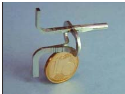
▲ Fig. 6 OMT aluminum mandrel.
